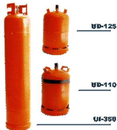
Las bombonas de butano/propano se deben almacenar en un lugar en que estén en todo momento por debajo de los 50 °C, correctamente ventilado (el propano y el butano pesan más que el aire) y alejado de cualquier fuente de ignición. Las botellas de butano/propano, distarán como mínimo **0,30 metros** de los **interruptores** y de los **conductores eléctricos**, y de **0,50 metros** de los **enchufes**. Deben protegerse de la suciedad y de la lluvia.
