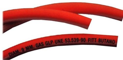
La longitud de la tubería flexible no será mayor de 1,50m. excepto en el caso de aparatos móviles de calefacción (estufas), en que no puede superar los 0,60m. No se permite la conexión directa de más de dos aparatos a una botella de uso doméstico a través de tuberías flexibles. En el caso de que se conecten dos aparatos de consumo a una misma botella por medio de tubería flexible, su longitud desde el manorreductor hasta el aparato no podrá ser mayor de 1,50m.
